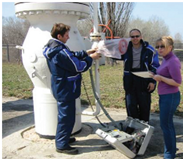
Los técnicos usan una sonda de muestreo de flujo alto para cuantificar la tasa de fugas de emisiones de metano en una estación de compresión de Cherkasytransgas.
